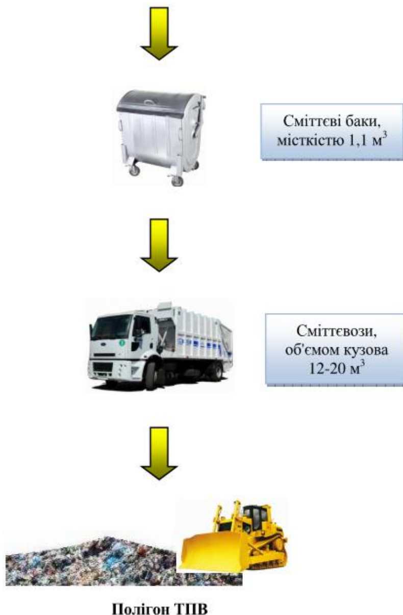
Рис 2.4. Типова система збирання твердих побутових відходів з вивезенням на полігон ТПВ
